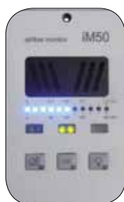
Устройство мониторинга воздушного потока в вытяжном шкафу
